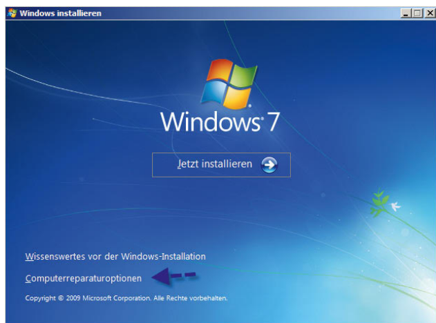
Abbildung 2.15 Starten der Computerreparaturoptionen für die parallele Installation von Windows 7 und Windows XP
