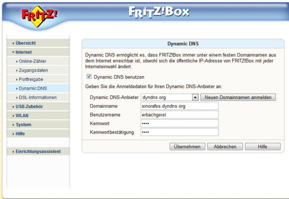
Abbildung A.42 Die Fritz!Box kann direkt für die Verwendung von DynDNS konfiguriert werden.
